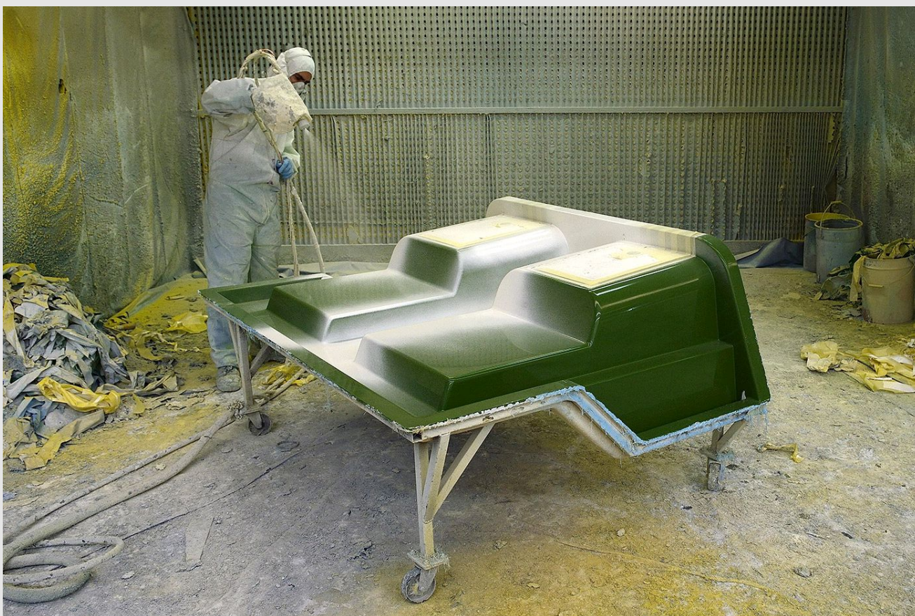
Fabrication de pièces en matériaux composites, avec un mélange de tissus en fibres de verre et de résine contenant du styrène classé comme CMR
