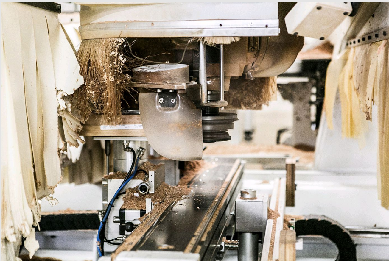
Tête de découpe d'une machine d'usinage de bois, avec un système d'aspiration des poussières de bois
