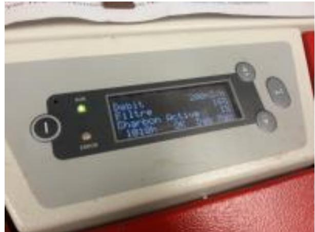
Le système dispose d'un **sur-filtre** qu'il est nécessaire d'aspirer régulièrement afin de ne pas bloquer l'aspiration. Il est impératif d'aspirer les poussières contenues dans le sur-filtre lorsque la capacité du filtre indiquée sur le système d'aspiration s'approche de 90 %. Si vous découpez des matériaux émettant beaucoup de poussière (acrylique, plexiglas, caoutchouc, ...), il est nécessaire d'aspirer le filtre à la fin de votre créneau.
